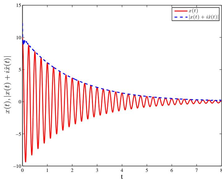
**Fig. 4:** Envelope detection using the DHT.
